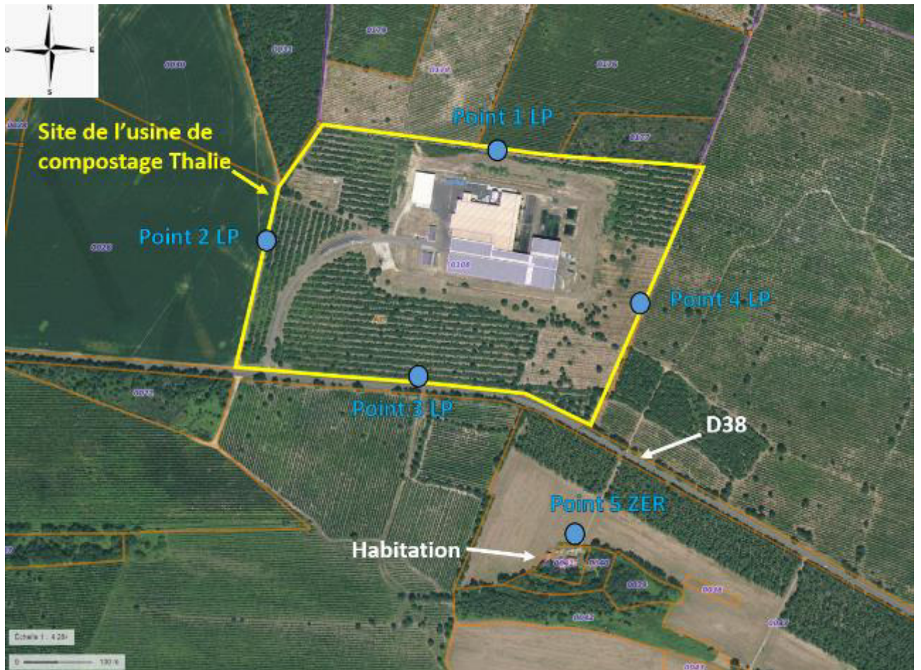
Figure 1 : Localisation des points de mesure sur le site de l'usine de compostage Thalie.
